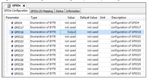
Um die Ein- und Ausgänge zu verwenden, ist im Reiter "GPIOs I/O Mapping" je ein DWORD definiert. Deren Bit <X> steht für den Wert des GPIO<X>.
