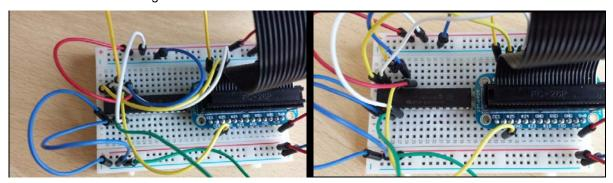
Bei den Geräte-Einstellung kann man auswählen, welche der GPIO-Pins als Input und welche als Output verwendet werden sollen. Für die Inputs kann man zudem einen Pullup-Widerstand aktivieren. Je nach Belegung der Adress-IO-Pins muss die Hardware-Adresse richtig eingestellt sein.
