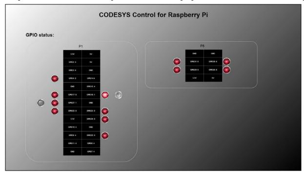
Um die zusätzlichen GPIOs der Modellvariante Raspberry Pi B+ zu verwenden gibt es ein eigenes, erweitertes GPIO-Gerät, welches man im Gerätebaum in den Slot "GPIOs" setzen kann.
